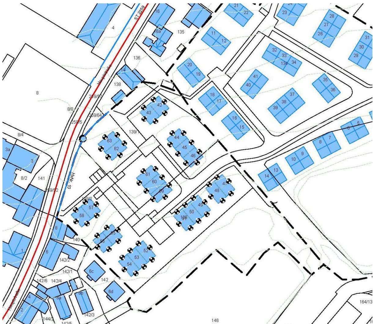
Lageplan im Schallschutzprogramm: 2. Bauabschnitt Wohngebiet "Am Schießberg" östlich der Hauptstraße (St 2259) mit geplanten Gebäuden und allen relevanten Immissionspunkten (inkl. Gebäude 1. BA)
